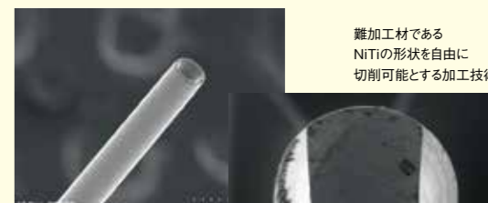
70ミクロンの針金に30ミクロンの穴を開けることを可能とする超微細加工技術
